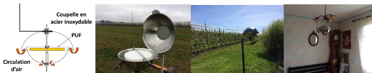
Figure 1 : Schéma et photos d'échantillonneur PUF déployés à proximité des vergers de pommier ou à l'intérieur des habitations.
