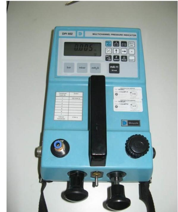
Etalonnage avec un calibrateur de pression (Druck DPI 602) raccordé COFRAC Gamme : 0 à -8 mH<sub>2</sub>O
