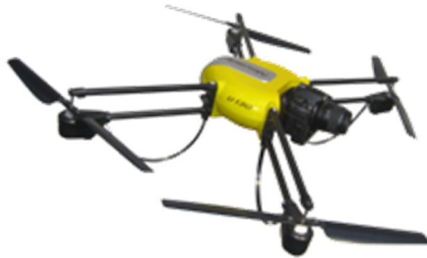
Drone + capteur multispectral HR + guidage et perception du terrain
