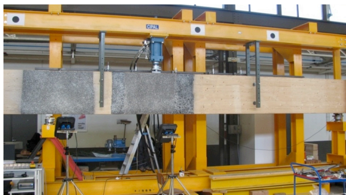
Figure 1 : Dispositif d'essai des poutres en flexion
