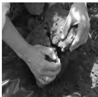
2. Observer la fragmentation du bloc et des mottes
