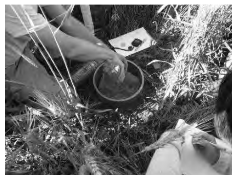
3. Verser le volume d'eau. Chronométrer jusqu'au ressuyage complet de l'eau. Répéter l'opération
