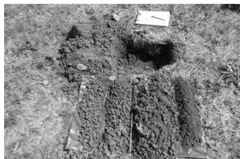
3. Estimer la proportion de cailloux, de terre fine et des différents types de mottes
