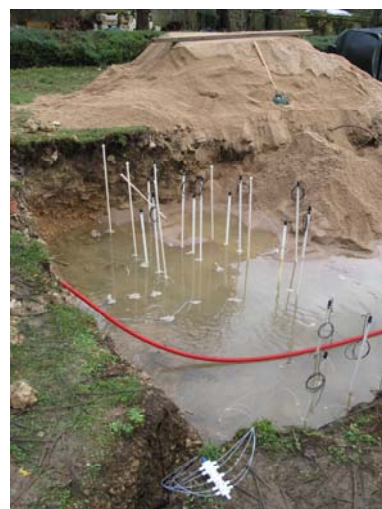
Figure 1. Dispositif d'instrumentation du sol sous un massif filtrant pilote. Coupe technique transversale à l'écoulement et photo d'ensemble de la fouille en cours d'équipement (fin décembre 2011). Au premier plan le collecteur des tubes connectés aux plaques poreuses déjà enfouies et le départ de la tranchée d'aménée des tubes et des câbles vers la centrale d'acquisition. Au second plan, les cannes des tensiomètres et de réservation pour les sondes de teneur en eau et les électrodes de résistivité. Au troisième plan, le sable de Loire de granulométrie recommandée par le Cémagref pour le massif filtrant non drainé en ANC.
