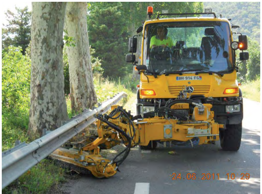
Photo 2 : outil de coupe escamotable sous les glissières
