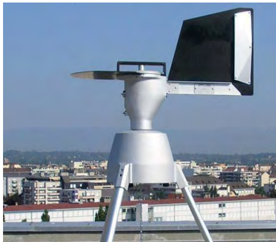
Figure 3 : capteur de pollens (pollen trap)
