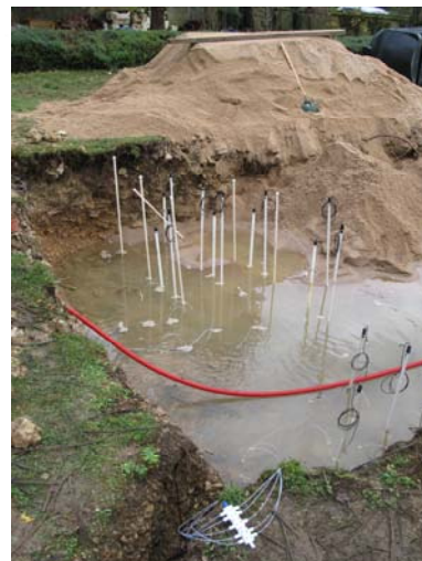
Figure 1. Dispositif d'instrumentation du sol sous un massif filtrant pilote. Coupe technique transversale à l'écoulement et photo d'ensemble de la fouille en cours d'équipement (fin décembre 2011). Au premier plan le collecteur des tubes connectés aux plaques poreuses déjà enfouies et le départ de la tranchée d'amenée des tubes et des câbles vers la centrale d'acquisition. Au second plan, les cannes des tensiomètres et de réservation pour les sondes de teneur en eau et les électrodes de résistivité. Au troisième plan, le sable de Loire de granulométrie recommandée par le Cémagref pour le massif filtrant non drainé en ANC.
