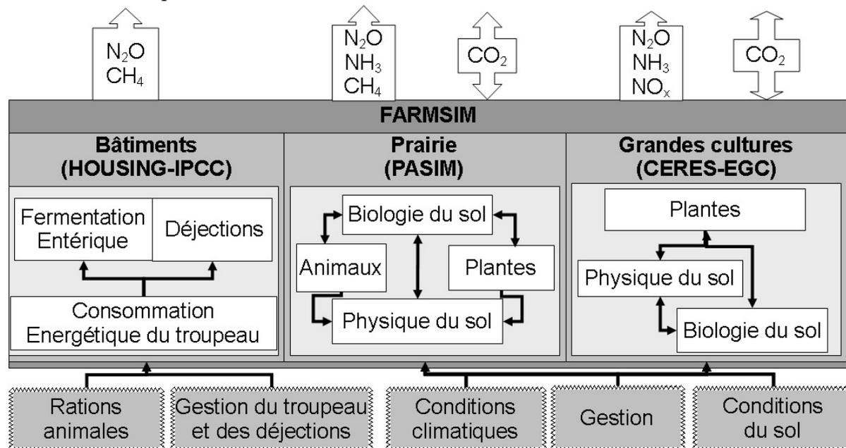
**Figure 2 :** Structure globale du modèle FARMSIM, faisant apparaître les trois modules constitutifs ; HOUSING-IPCC, PASIM et CERES-EGC). Le type d'information nécessaire en entrée du modèle figure en bas de la figure ; les sorties (flux GES) en haut.
