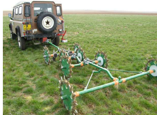
Fig. 1 – Système GPR (gauche) et géoélectrique MUCEP (droite).
