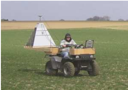
Fig. 1 – Système GPR (gauche) et géoélectrique MUCEP (droite).
