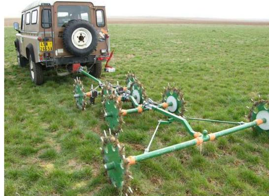
Fig. 1 – Système GPR (gauche) et géoélectrique MUCEP (droite).
