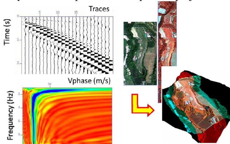
**Fig. 2 – Enregistrement sismique (gauche, haut) et diagramme mettant en évidence la dispersion des ondes de surface (gauche, bas). Traitements (orthorectification, coregistration) appliqués aux images hyperspectrales.**
