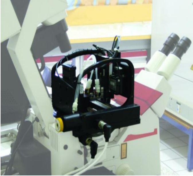
Figure 1: Dispositif rhéo-optique placée sur un Microscopie Confocale à Balayage Laser [6]
