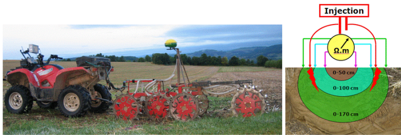
Fig. 1 – ARP : dispositif tracté de mesure de la résistivité électrique en continu
