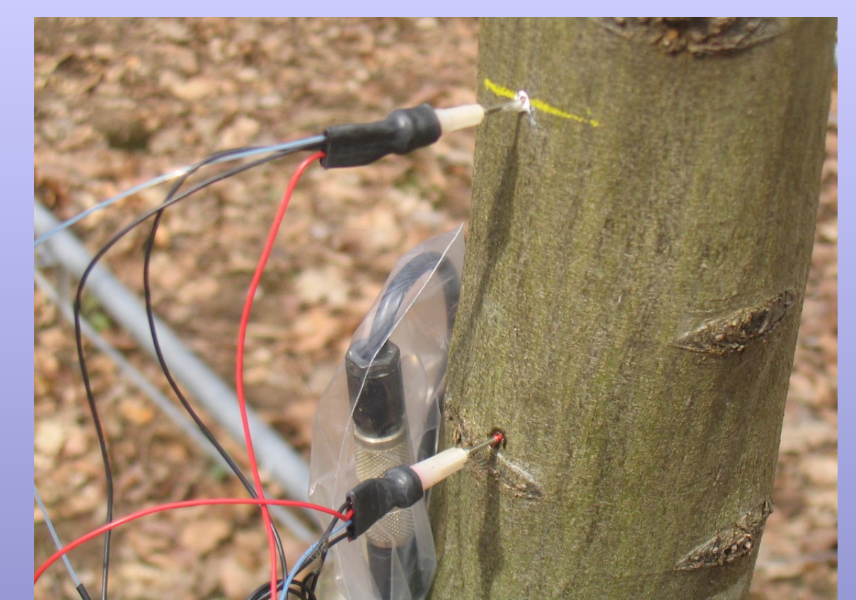
Capteur de flux de sève (Granier et al. , 1985;1987)
