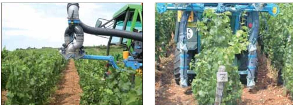
Photos 1 et 2 : Rampe CG (gauche) traitant par le dessus de la végétation et rampe AB most (droite) traitant dans l'inter-rang
