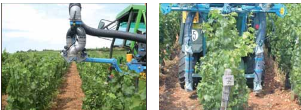
Photos 1 et 2 : Rampe CG (gauche) traitant par le dessus de la végétation et rampe AB most (droite) traitant dans l'inter-rang Over head sprayer (CG - left) and in between rows sprayer (AB most - right)
