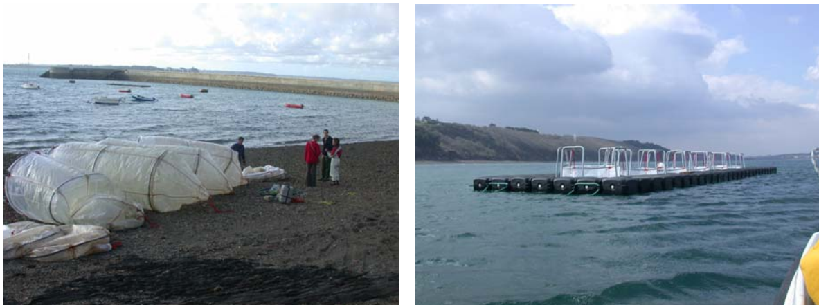
Figure 1. Sacs expérimentaux (diamètre : 1,60 m ; hauteur : 4 m) et ponton (longueur 25 m sur 5 m de large) mis en oeuvre pour les études en mésocosmes.
