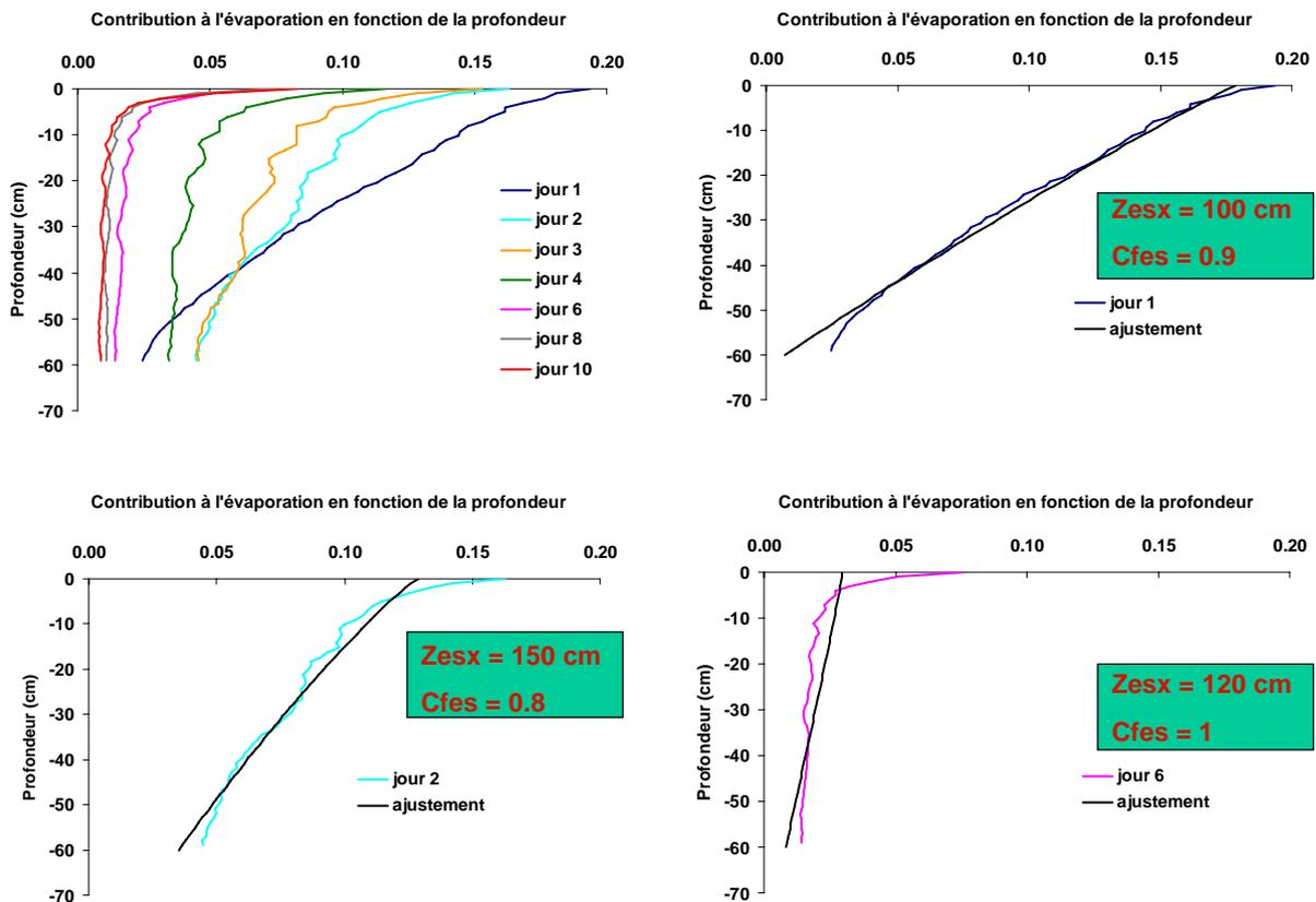
**Figure 2 :** Estimation des paramètres *zesx* et *cfes* par ajustement de l'équation de la répartition de l'évaporation implémentée dans STICS (Brisson et Mary, 2002). Simulations réalisées avec HYDRUS-1D sur sol de Mons à une masse volumique constante de  $1.3 \text{ g cm}^{-3}$  sur 60 cm d'épaisseur. Pas de précipitation et une ETP de  $1 \text{ mm jr}^{-1}$  pendant 10 jours.
