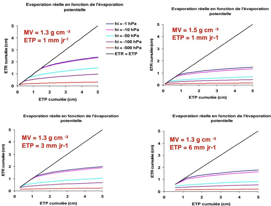
**Figure 3:** Estimation du paramètre  $q_0$ . Simulations réalisées avec HYDRUS-1D sur sol de Mons avec une masse volumique de 1.3 ou de 1.5  $\text{g cm}^{-3}$  sur 60 cm de profondeur, pour des conditions initiales du potentiel hydrique variant de -1 à -500 hPa. Pas de précipitation, ETP journalière variable de 1 à 6 mm pendant 60 jours.
