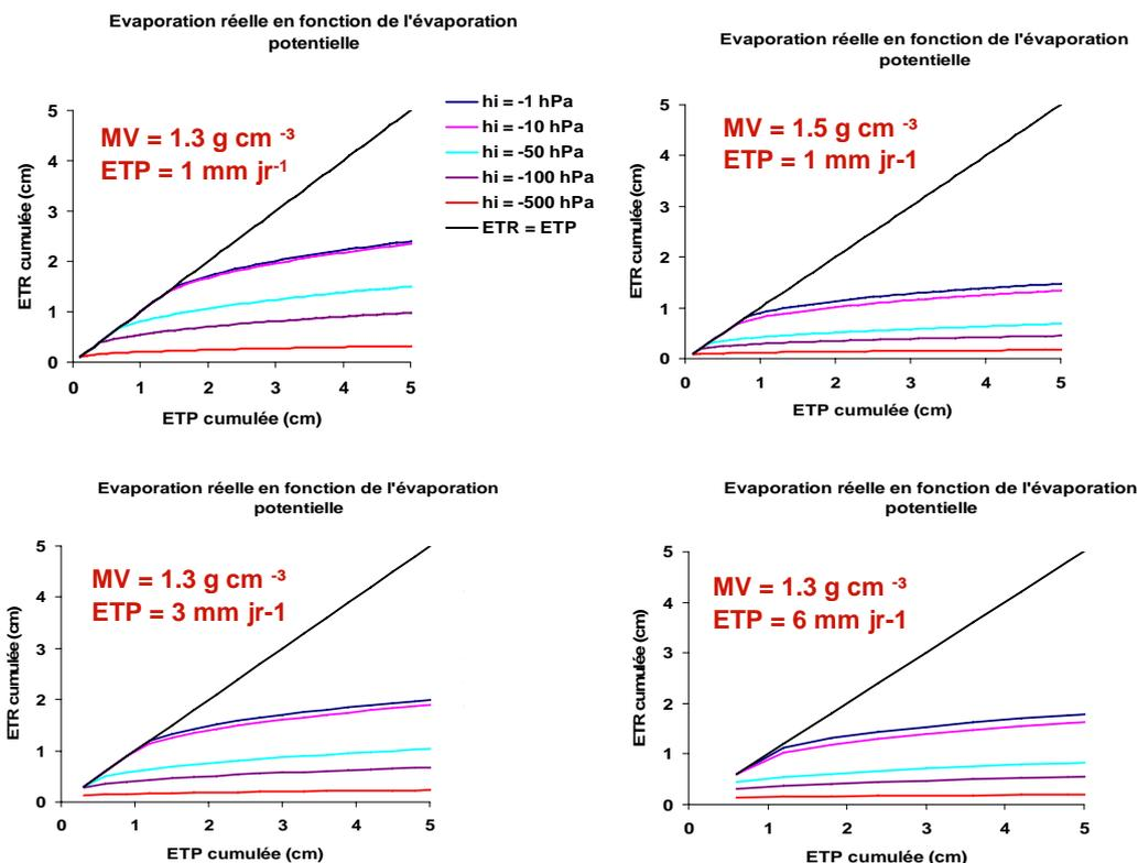
**Figure 3:** Estimation du paramètre  $q_0$ . Simulations réalisées avec HYDRUS-1D sur sol de Mons avec une masse volumique de  $1.3$  ou de  $1.5 \text{ g cm}^{-3}$  sur  $60 \text{ cm}$  de profondeur, pour des conditions initiales du potentiel hydrique variant de  $-1$  à  $-500 \text{ hPa}$ . Pas de précipitation, ETP journalière variable de  $1$  à  $6 \text{ mm}$  pendant  $60$  jours.
