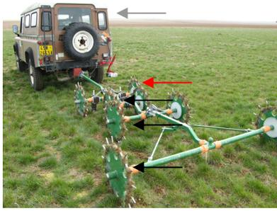
Dispositif électronique : résistivimètre, Radar, dGPS
