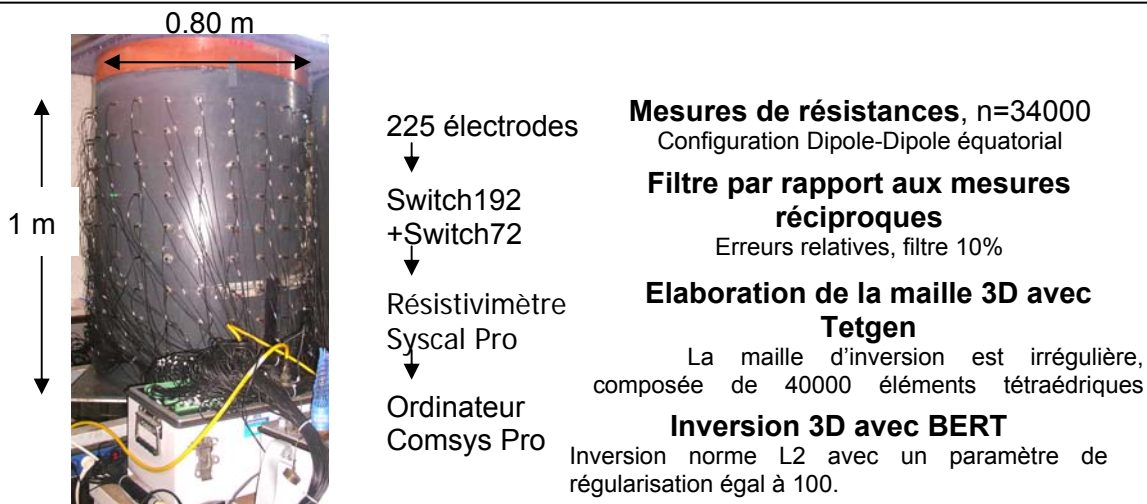
Figure 1 : Dispositif de tomographies sur colonne et traitement de données.
