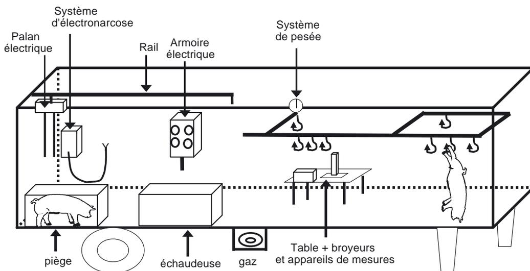
Figure 1 - Schéma de l'abattoir conçu dans une semi-remorque
