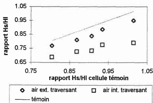
Si l'on s'affranchit de la quantité de chaleur produite pour ne regarder que le partage de cette quantité entre part sensible (élévation de température) et part latente (évaporation de l'eau), on constate sur la fig. 5 que ce partage ne peut expliquer les écarts de production d'ammoniac. La litière traversée par de l'air en provenance de l'extérieur a en effet un rapport des flux intermédiaire alors qu'elle produit sensiblement moins d'ammoniac que les deux autres.
