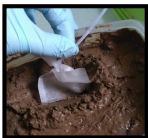
Figure 5 Mise en place d'une DMG dans le sol
