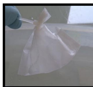
Figure 4 Fermeture du sachet de thé par un collier de serrage
