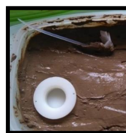
Figure 6 DMG enterré et DGT enfoncé dans le sol
