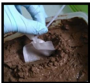
Figure 5 Mise en place d'une DMG dans le sol
