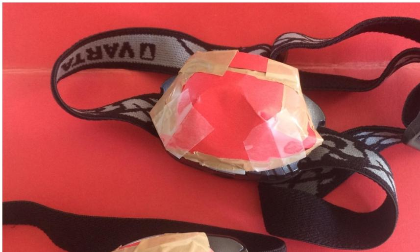
*Figure 9 : Lampe frontale équipée d'un filtre rouge très occultant, de façon à ne laisser passer qu'un flux faible et invisible par les boucs*
