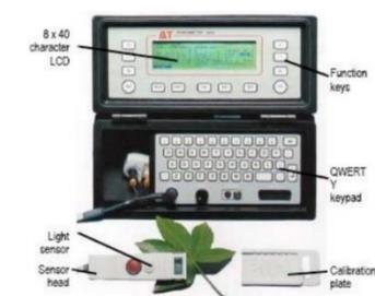
Figure 5. Poromètre AP4 de Delta T.
