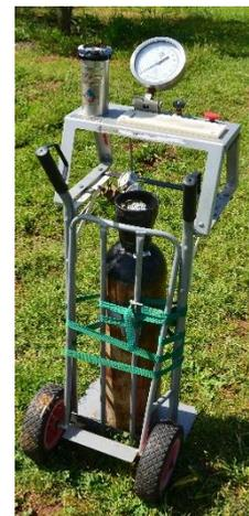
Figure 4. Photographie d'une chambre à pression utilisées.
