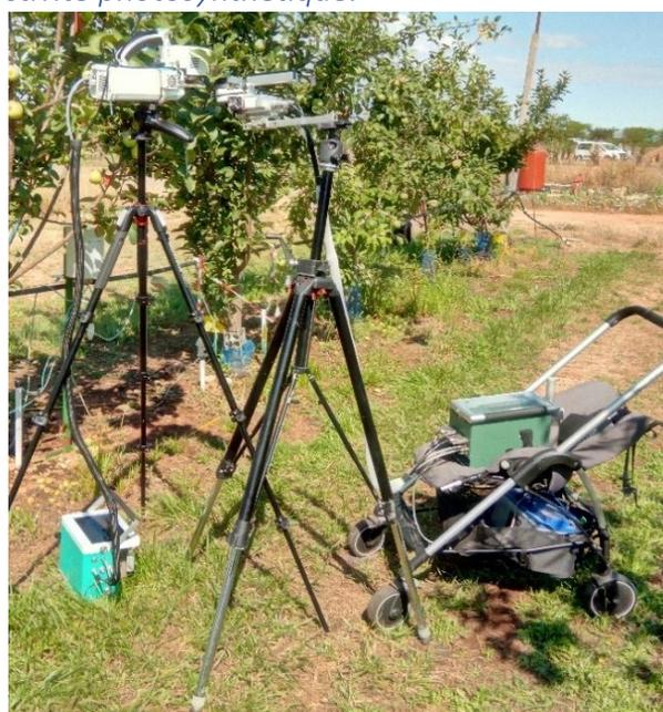
Figure 6. LICOR 6800 (à gauche) et LICOR 6400 (à droite).
