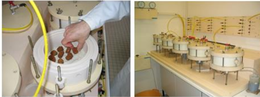
Figure 10 : Mesure au laboratoire des propriétés de rétention en eau sur les mottes de sol prélevées sur les fosses pédologiques
