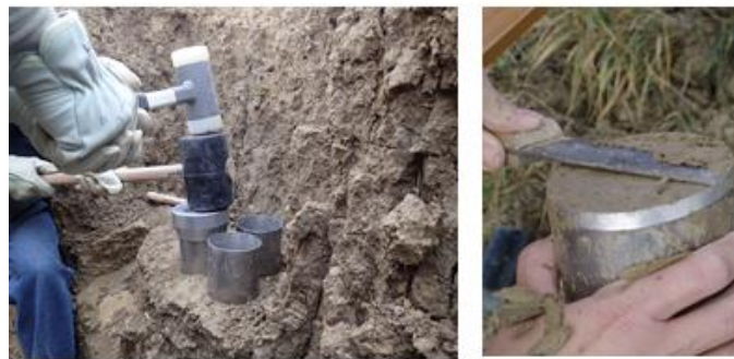
Figure 8 : Méthode de prélèvement de sol au cylindre pour la mesure de masse volumique
