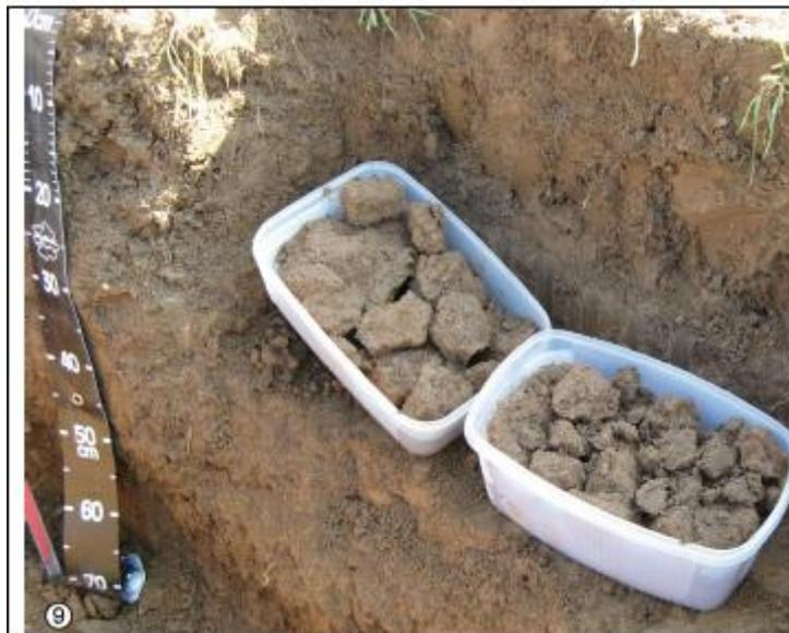
Figure 9 : Prélèvement de mottes de sol pour la mesure de teneurs en eau à potentiels hydriques connus au laboratoire
