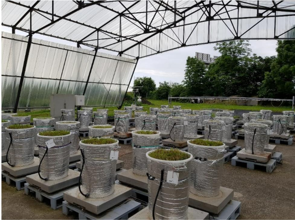
Figure 3 : Dispositif expérimental composé de 30 mésocosmes
