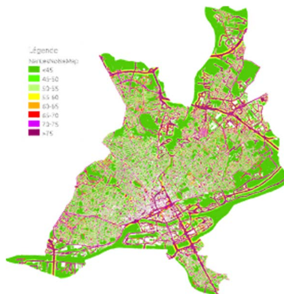
Figure 3-11. Carte de bruit de la ville de Nantes, obtenue avec le modèle NMPB2008 et avec le logiciel open source "NoiseModelling"
