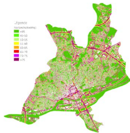
Figure 29. Carte de bruit de la ville de Nantes, obtenue avec le modèle NMPB2008 et avec le logiciel open source « NoiseModelling »
