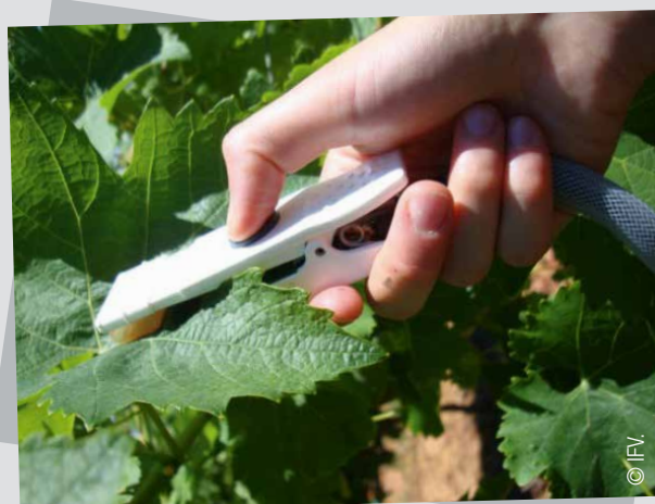
Mesure de la résistance stomatique avec un poromètre AP4.
