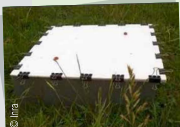
Chambre sans réhausse avec des clips pour étanchéifier
