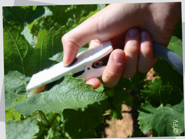
Mesure de la résistance stomatique avec un poromètre AP4.
