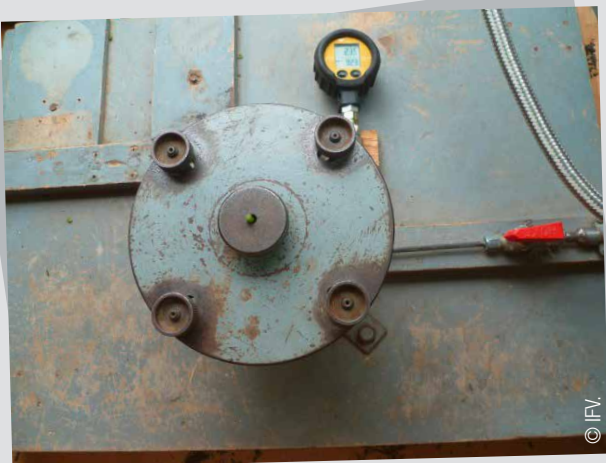
Mesure du potentiel hydrique foliaire de tige dans une chambre à pression.
