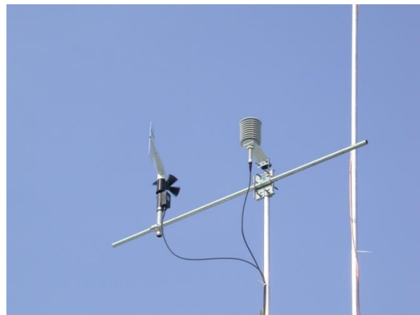
Figure C5.5. Station météorologique (mesures de vent, de température et d'humidité)
