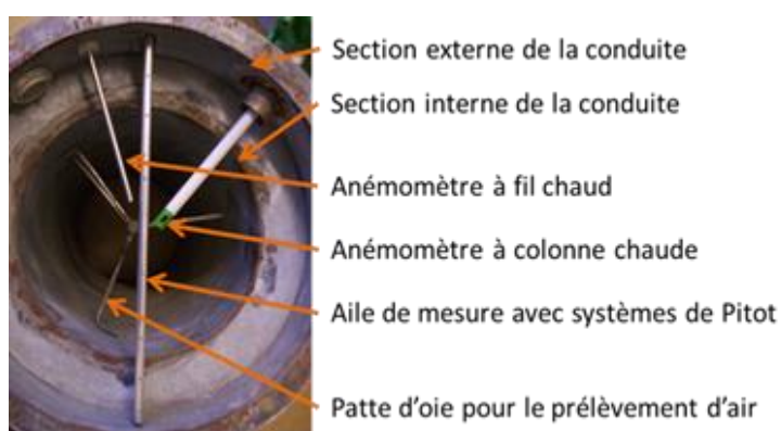
Figure M24.2. Coupe de la conduite
