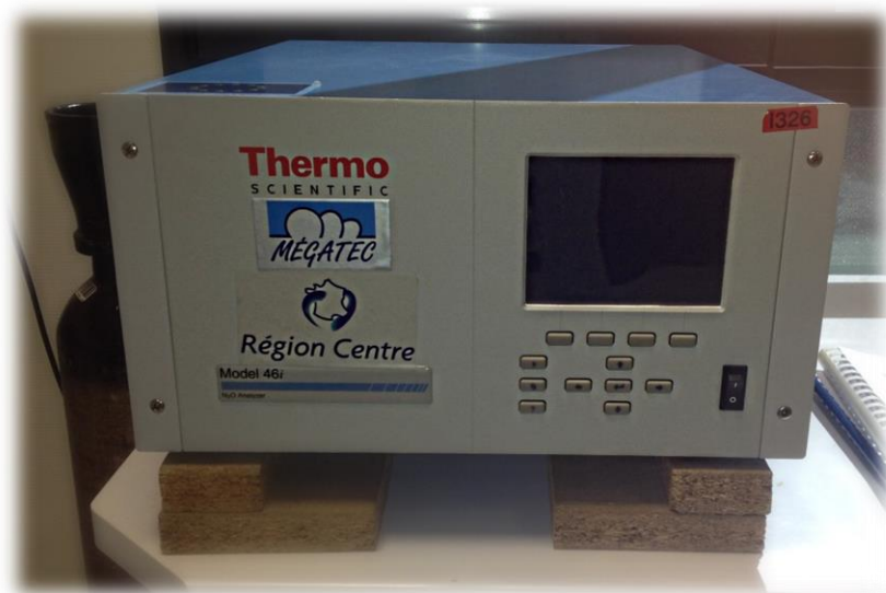
Figure 10 : Analyseur de N 2 O à corrélation IR (Mégatec 46i)
