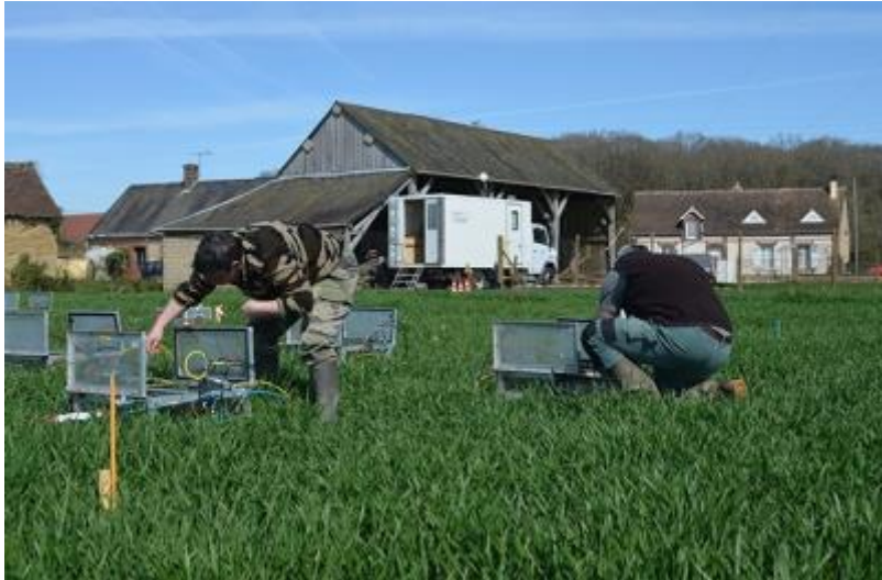
Chambres automatiques permettant de mesurer localement les flux de N 2 O à la surface du sol
