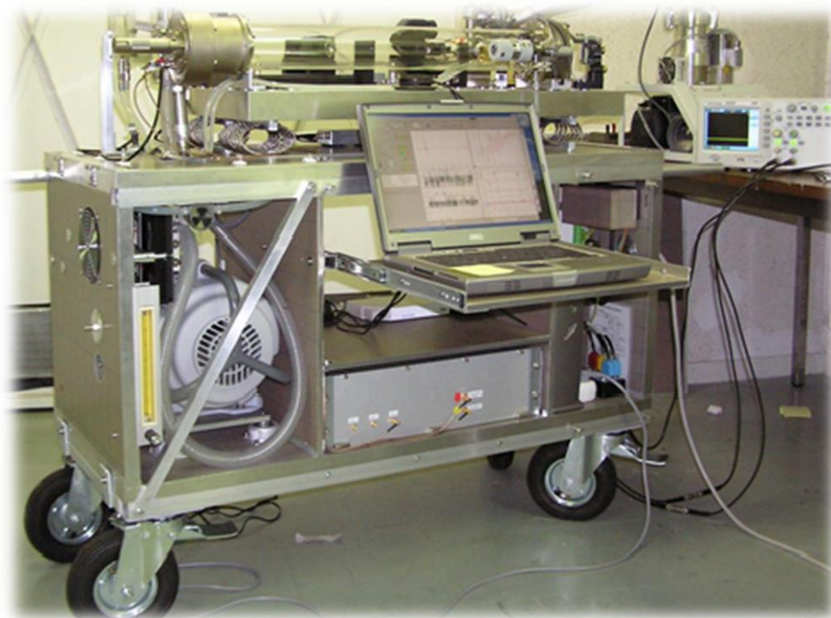
Figure 9 : Spectromètre Infra Rouge In situ Troposphérique SPIRIT sur banc mobile
