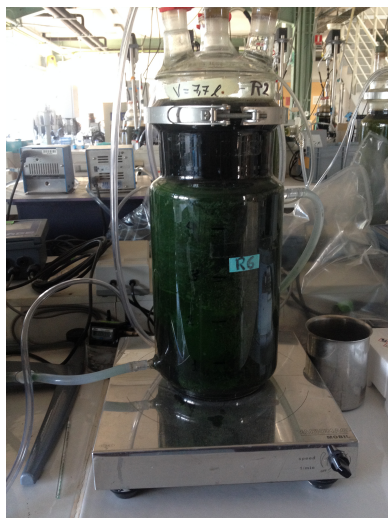
Figure 1: Bioréacteur contenant des micro-algues.
