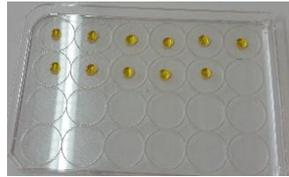
Figure 15. Plaque pour comptage des larves (test de dégagement après contact avec les tanins)
