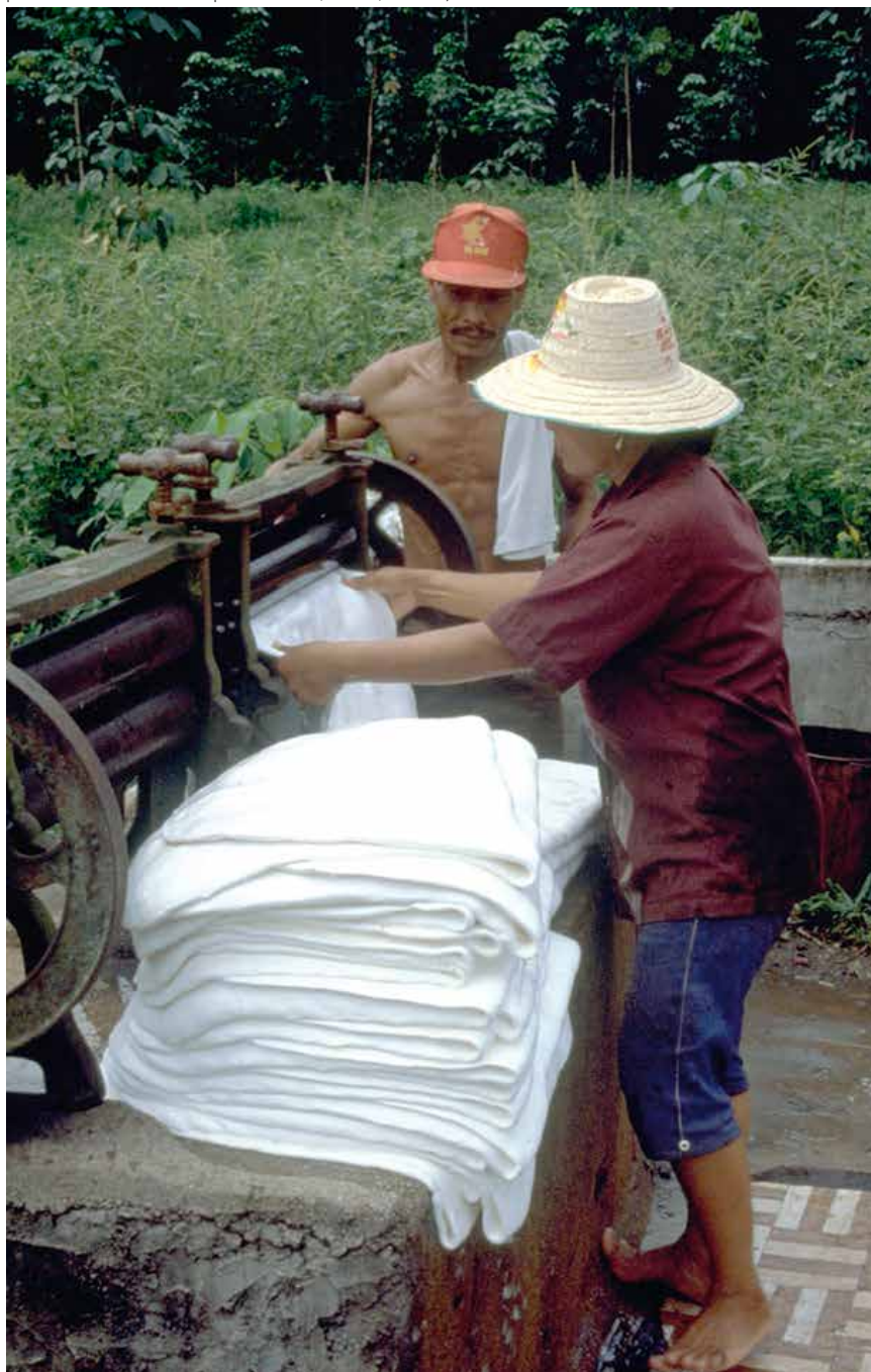
Presse de l'atelier de traitement du latex, essorage artisanal du latex pour la fabrication des feuilles de crêpe de caoutchouc (Thaïlande). © Cirad - Guy Tiébuil
