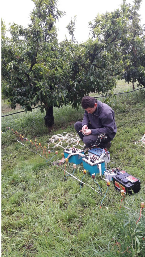
Figure 4 : Mise en œuvre d'un dispositif de tomographie électrique avec 32 électrodes espacées de 20 cm
