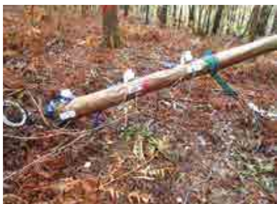
Figure 1 : Petit Eucalyptus globulus après arrachage montrant le capteur de force servant à mesurer la force de tractions, et des inclinomètres utilisés dans la mesure d'inclinaison de la tige.
