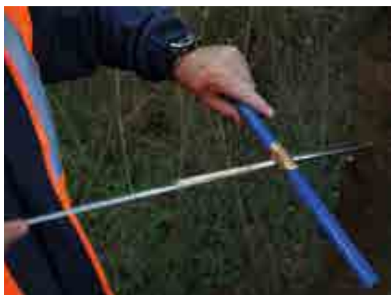
Figure 2 : Prélèvement de carottes à la tarière de Pressler sur les dispositifs expérimentaux (Photo : D.Michaud).
