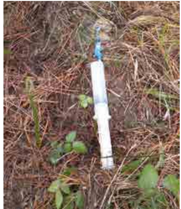
Figura 4: Capsula de succión establecida en campo para la monitorización de la ecotoxicidad de la aplicación de biochar y ceniza de caldera de biomasa. (Foto: Ander Arias González, NEIKER).
