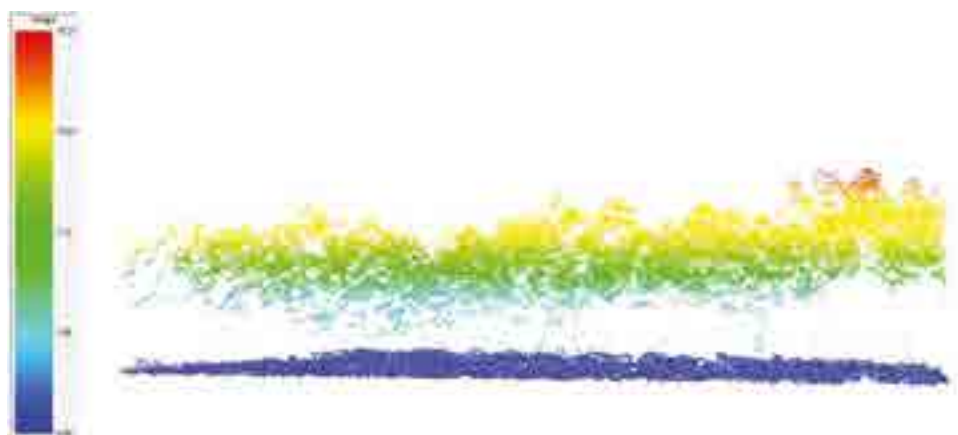
Figura 1: Nube de puntos normalizado para datos LiDAR de 8 pulsos m^2 en la subparcela control del monte de Barcia.
