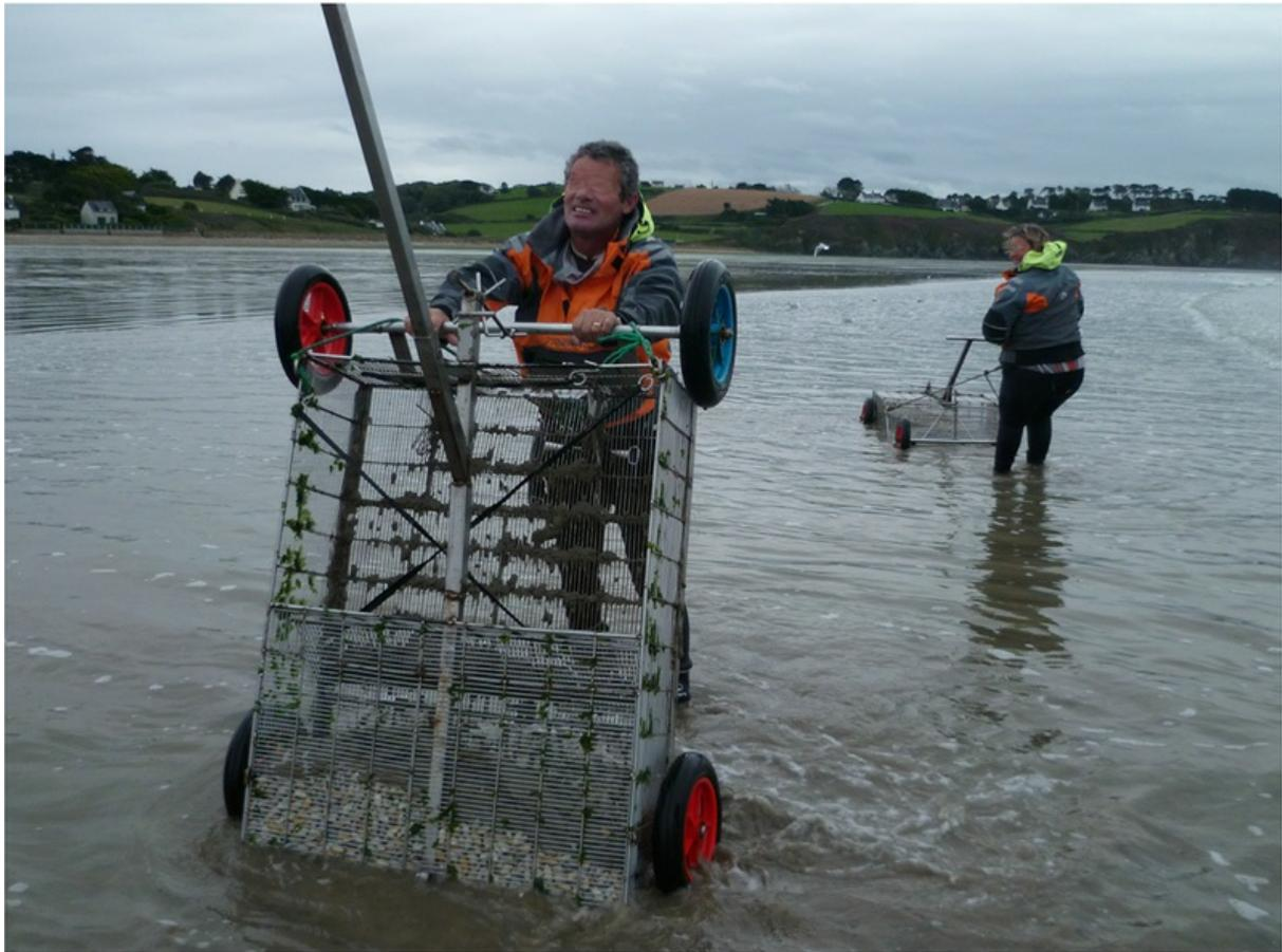
**Figure 4.1. Soulèvement de la drague pour enlever le sable.**
