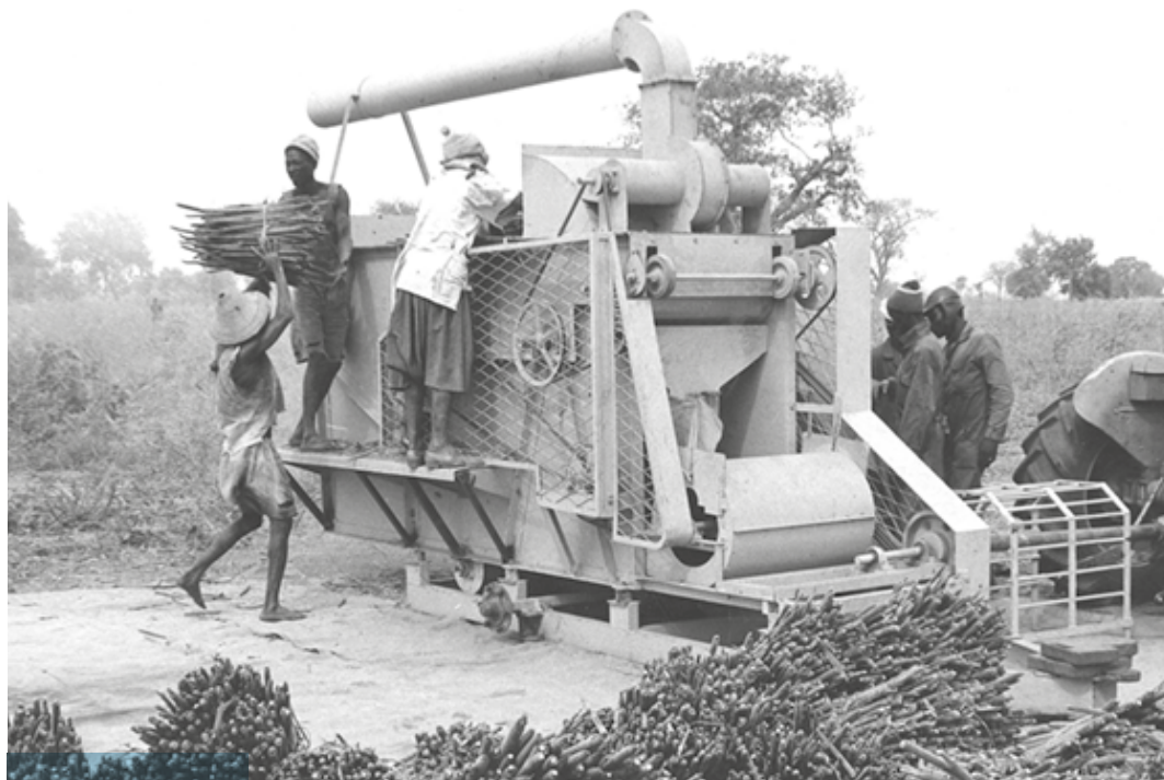
Une autre avancée par le moteur, bien trop ignorée : la « batteuse à mil », première machine capable de libérer la femme africaine d'un travail long, pénible et contraignant. Conçue sur un brevet Tourte-Plessard, une première série en est fabriquée, en septembre 1965, par la Société industrielle sénégalaise de Constructions mécaniques et de Matériels agricoles, Siscoma.
