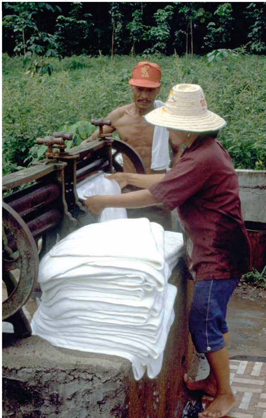
Presse de l'atelier de traitement du latex, essorage artisanal du latex pour la fabrication des feuilles de crêpe de caoutchouc (Thaïlande). © Grad - Guy Trébut
