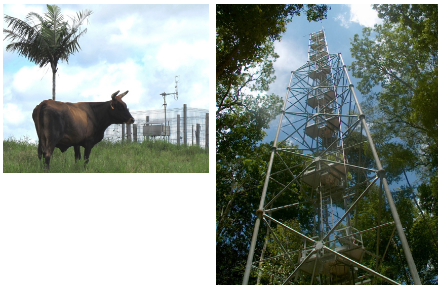
Figure 2: Vue d'une tour à flux sur prairie (dispositif Carpagg) et en forêt (dispositif Guyaflux). La tour Guyaflux d'une hauteur de 55m, permet de positionner les capteurs à 20 m au-dessus de la forêt intégrant les flux de CO 2 sur une surface de 50-100 ha. En prairie, une hauteur de 2m est suffisante et permet de limiter la surface de captage à l'échelle de la parcelle (8 ha).
