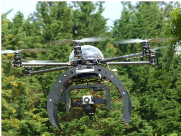
Drone « Tetis » équipé de deux boîtiers RVB & proche infrarouge
