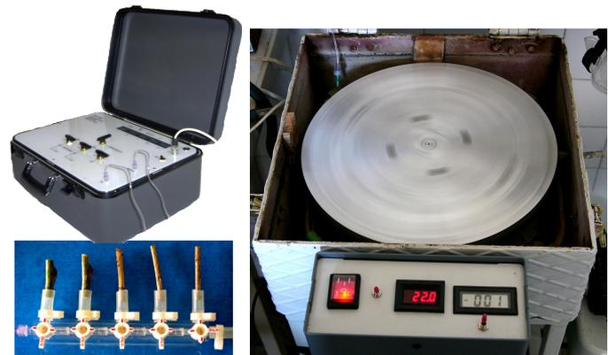
Fig 3: Outils de mesure de l'embolie : XYL'EM (à gauche) et CAVITRON
